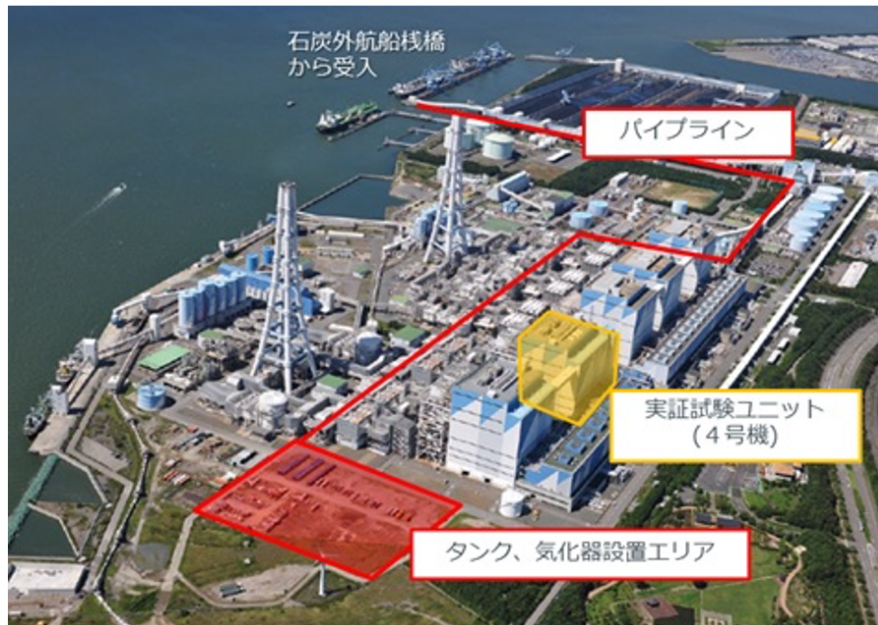
図A1 - 碧南火力発電所でのアンモニア実証事業について (JERA, 2023 c)
